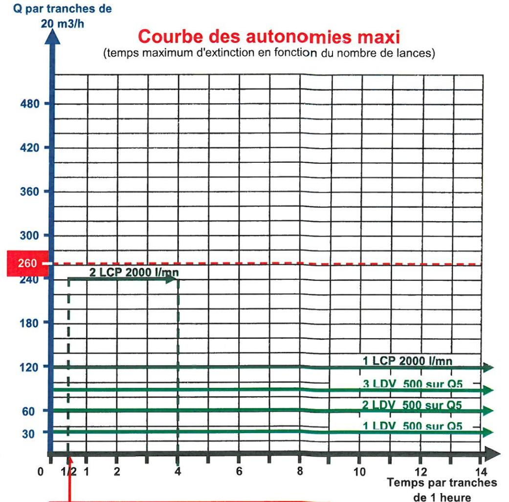
Alimentation sur réserve incendie n°100 avec C.D (jusqu'à 500m d'établissement) ou via colonne sèche Ø200 mm (brides d'alimentation n°096 et brides de refoulement n°097), avec une M.P.R 120 m<sup>3</sup>/h
