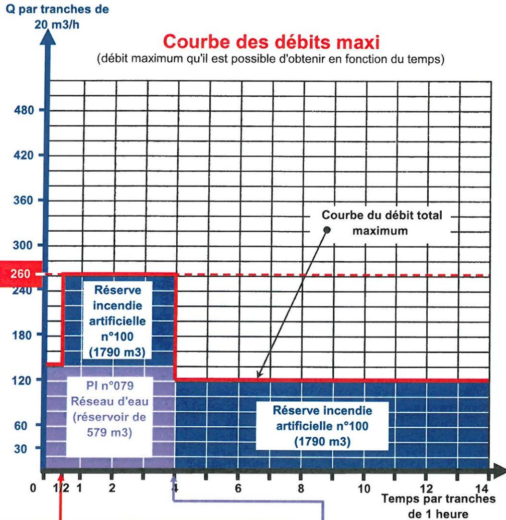
Alimentation sur réserve incendie n°100 avec C.D (jusqu'à 500m d'établissement) ou via colonne sèche Ø200 mm (brides d'alimentation n°096 et brides de refoulement n°097), avec une M.P.R 120 m<sup>3</sup>/h
